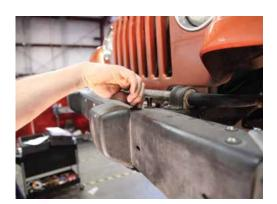
**STEP 14**Install steering box bolt.
